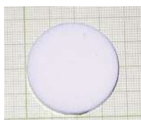
Biocéramique « basse température » d'apatite nanocristalline consolidée par SPS à 150 °C/100 MPa (13 min.)
